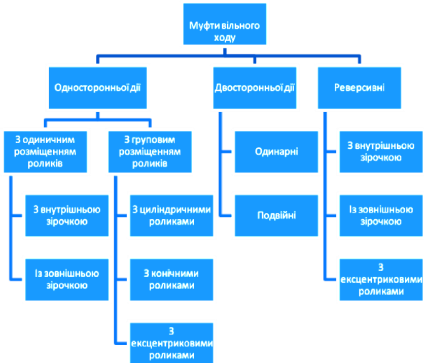
Рисунок 1.1.1 – Класифікація роликових муфт вільного ходу
