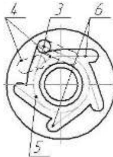
Рисунок 2.1.11 - Взаємне розташування пазів півмуфт під час зачеплення (пази ведучої півмуфти наведено пунктирними лініями)
