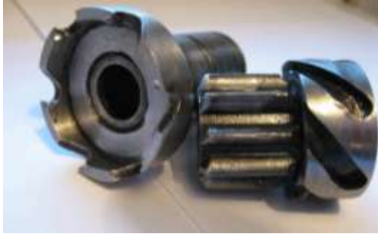
Рисунок 3.4.5 — Загальний вигляд ведучої і веденої півмуфт після граничних навантажень
