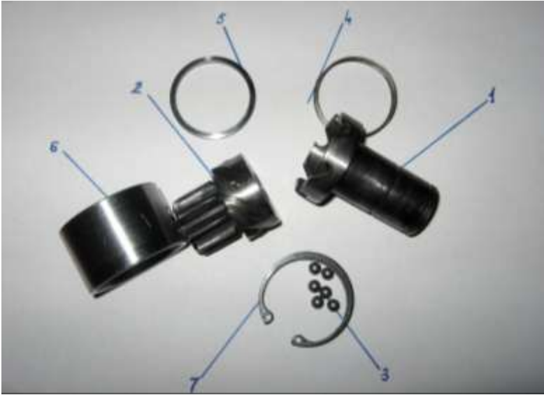
Рисунок 3.4.1 — Деталі дослідного зразка (натурної моделі) кулькової обгінної муфти зачеплення
