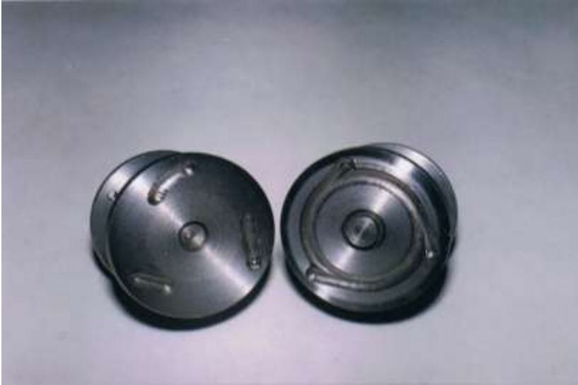
Рисунок 2.3.5 – Півмуфти кулькової муфти вільного ходу (по-детально)
