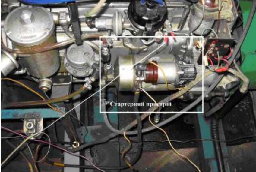
Рисунок 3.4.4 — Загальний вигляд стартера з кульковою обгінною муфтою, змонтованого на двигуні внутрішнього згоряння
