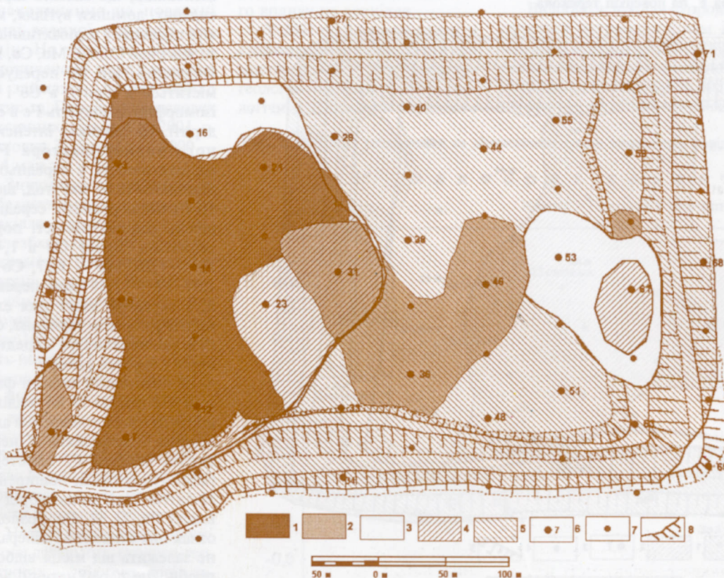
Рис. 4. Розподіл навантаження фактора F 2 і звітрілості порід на поверхні терикона
