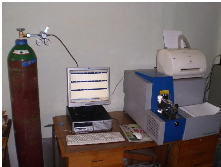
Рис. 1. Спектральний аналізатор SPECTROMAXx
