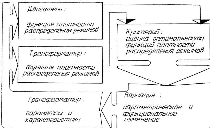
Рис. 2.2. Схема оптимизации параметров и характеристик трансформатора.
