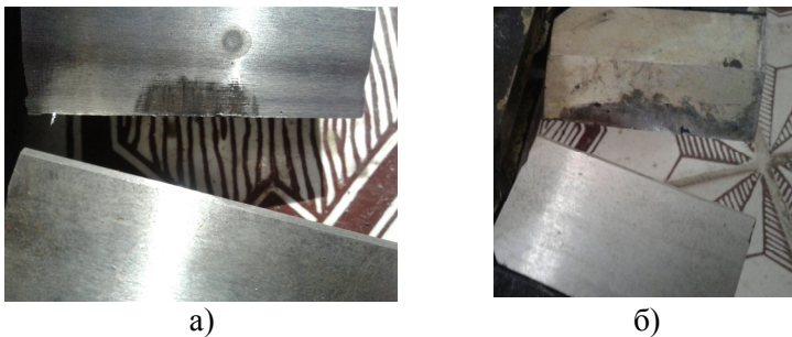
Рис. 4. Загальний вигляд ріжучих елементів після 200-го різання а) ніж із наплавленим покриттям; б) ніж серійного виробництва
