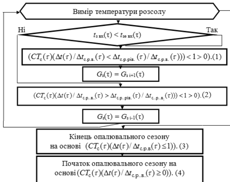
Рис. 2. Структурна схема прийняття рішень щодо розряду ґрунту у складі динамічної системи: ґрунтовий теплообмінник – випарник теплового насосу
