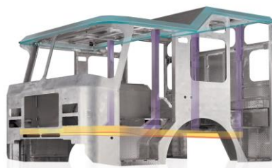
Рисунок 13 — Кабіна E-One Turphoon з каркасом із надміцної сталі
