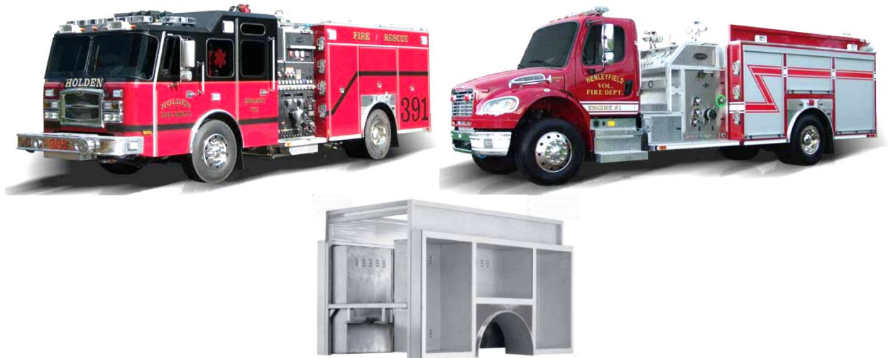
Рисунок 20 – Типова модульна надбудова та надрамник E-One
