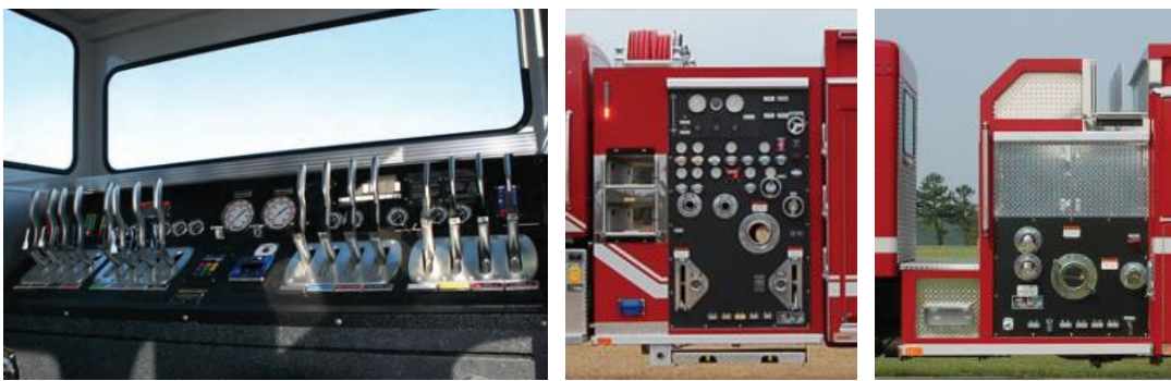
Рисунок 17 — Варіанти розташування пульта управління помпою
