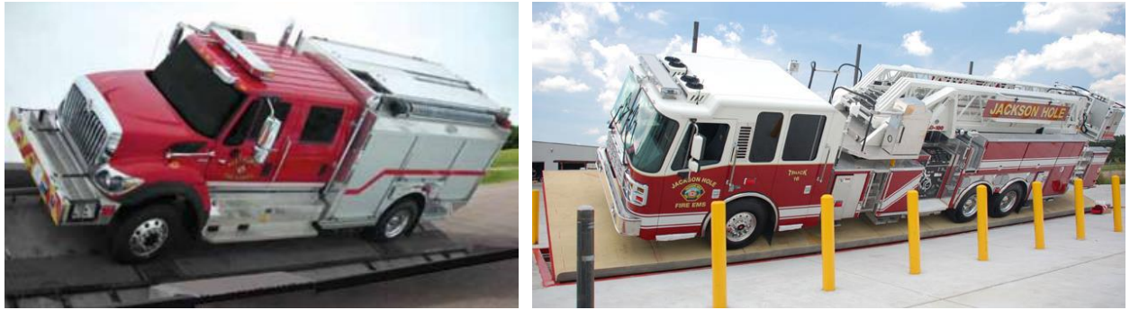
Рисунок 27 — Тестування шасі на поперечну стійкість
