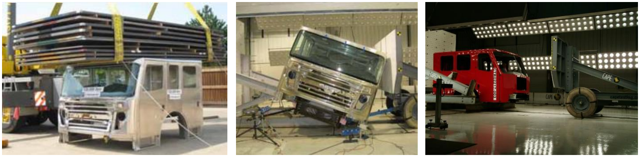
Рисунок 26 — Перевірка кабіни на міцність
