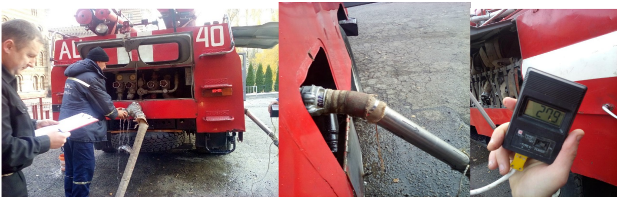
Рис. 3. Проведення експериментального дослідження нагріву води
