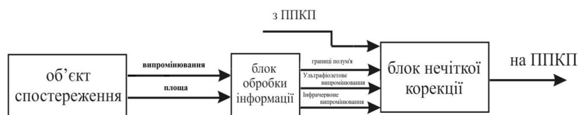
Рисунок 2 – Структурна схема пожежного сповіщувача полум'я
