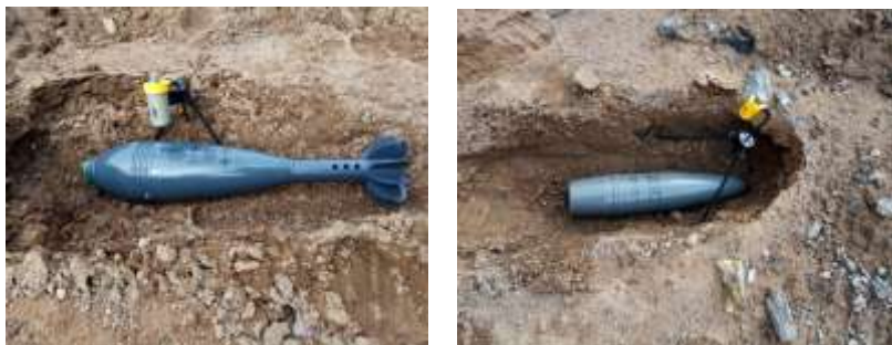
Рис. 1. Зразок застосування спеціальних зарядів під час знешкодження вибухонебезпечних предметів.
