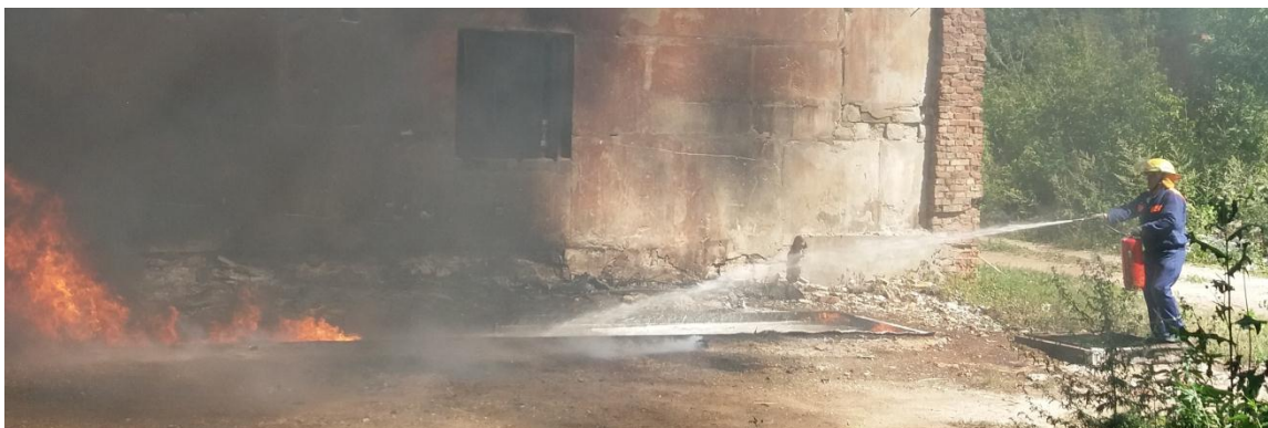
Рисунок 4 – Гасіння макетного вогнища площею 10 м 2 , вогнегасником водопінним ВВП-9(з) із зарядом «БАРС АFFF-1» з добавками
