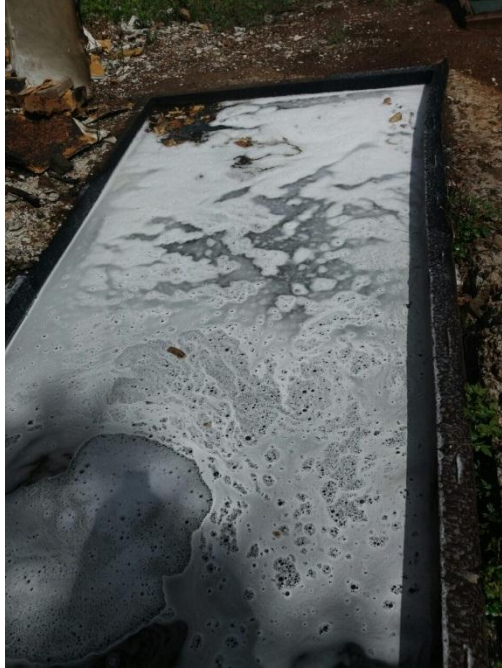
Рисунок 2 – Загашене макетне вогнище вогнегасником водопінним ВВП-9(з) із зарядом «БАРС АFFF-1» з добавками
