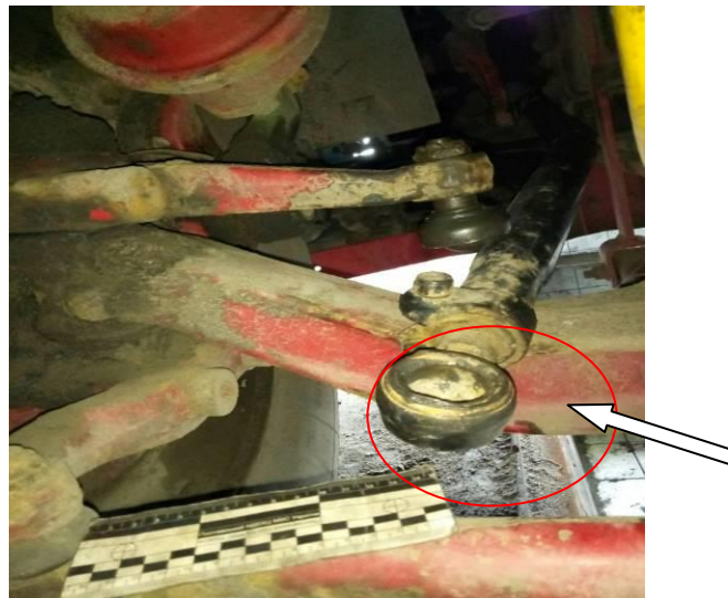
Рисунок 3 – Загальний вигляд пошкодження продольної рульової тяги автомобіля DAF XF 95
