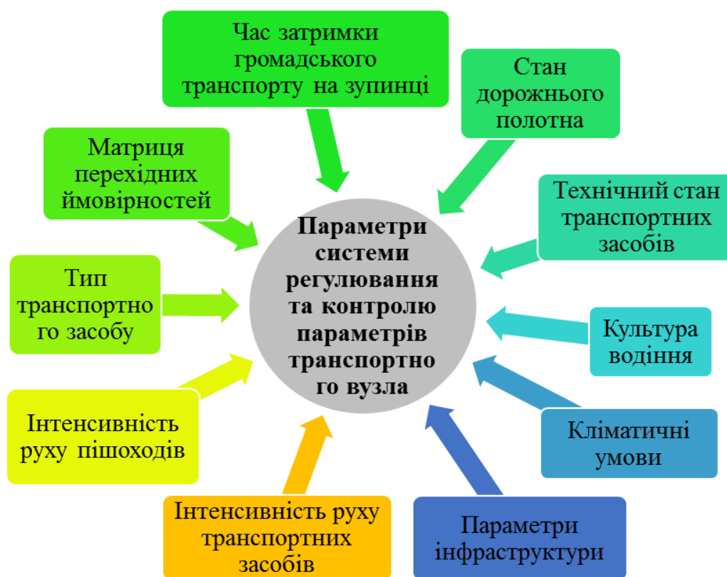
Рисунок 1 – Схема динамічної моделі визначення параметрів робочих
