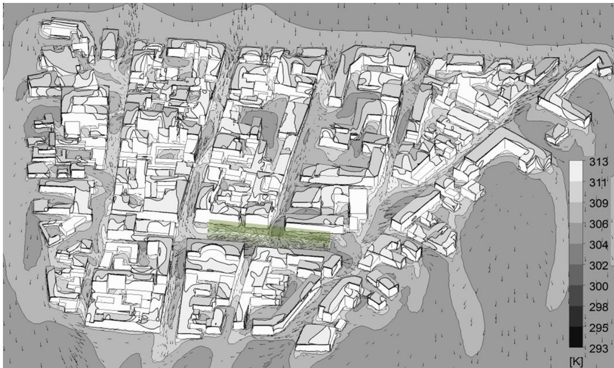
Рисунок 3 – Распределения температуры воздуха вблизи поверхности зданий и грунта при среднеквадратичном осреднении за период 0.5 часа дневного времени
