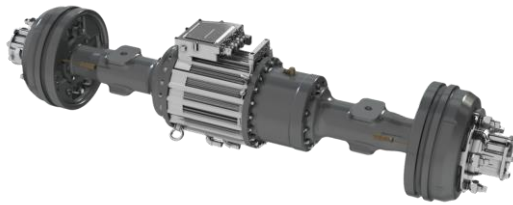
Рисунок 7 Привідний електричний міст американської фірми "Dana Inc."
