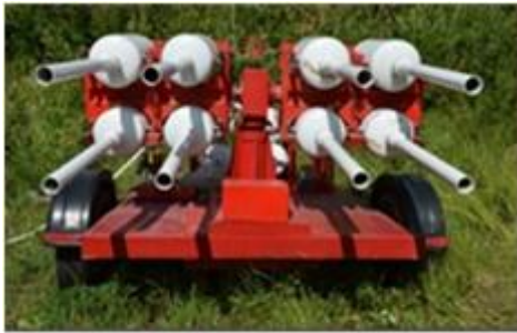
Рис. 1. Мобільний комплекс пожежогасіння «Граніт»
