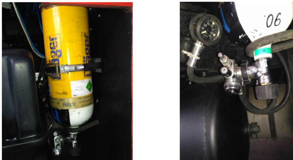
Рисунок 3 – Розміщення повітряного балона зі стисненим повітрям на АЦ-4-60(5309)-505М
