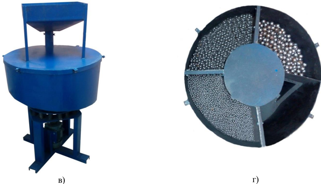
Рис.1. Розроблений вібраційний торovidний млин: а) – технологічна схема; б) – схема розміщення вібропривода конструктивна реалізація; в) – конструктивна реалізація; г) – торovidний сегментний контейнер
