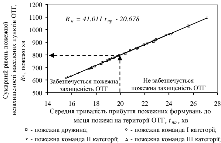
Рисунок 6 – Залежність сумарного рівня пожежної незахищеності ( R_n ) населених пунктів від середньої тривалості ( t_{np} ) прибуття окремих видів пожежних формувань до місця пожежі на території Жовтанецької ОТГ
