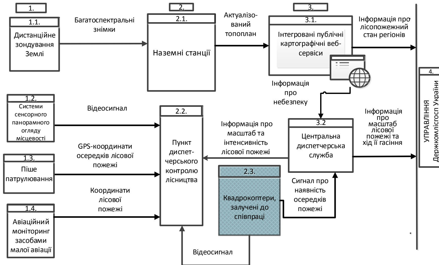
Рисунок 3.4 – Функціональна схема інформаційно-технологічного забезпечення моніторингу лісових пожеж
