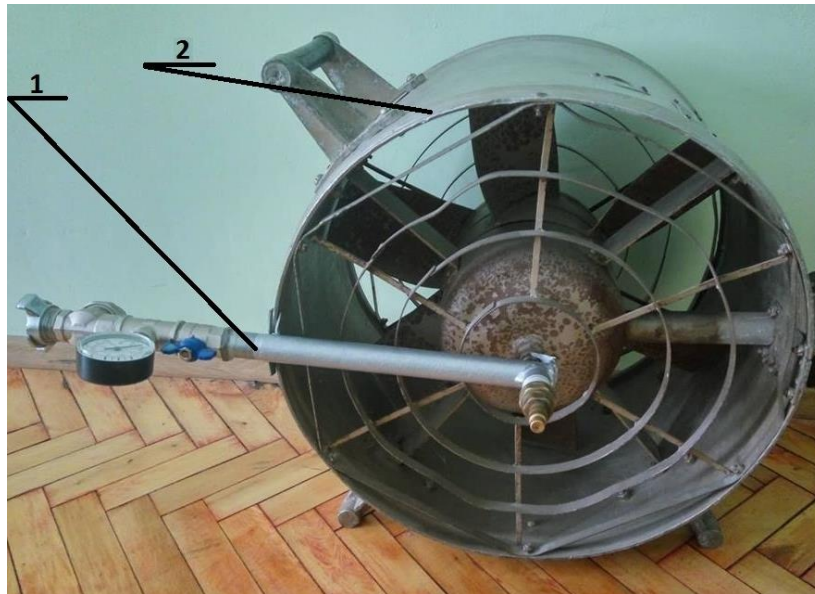
Рисунок 4.34 – Загальний вигляд пристрою разом з пожежним димовсмоктувачем: 1– пристрій для подачі ТРВ; 2 – переносний пожежний димовсмоктувач
