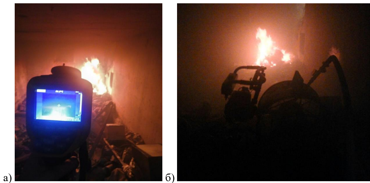
Рисунок 5.8 – Полігонні випробування: а) заміри середньо об'ємної температури за допомогою тепловізора Fluke TiS40; б) подача ТРВ пристроєм на базі ДПМ-7
