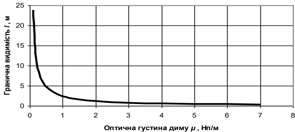
Рисунок 1.17 – Залежність граничної видимості від оптичної густини диму
