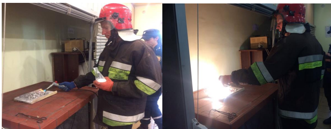
Рисунок 2.1 – Випробування вогнегасних порошків для гасіння сплавів магнію в лабораторних умовах
