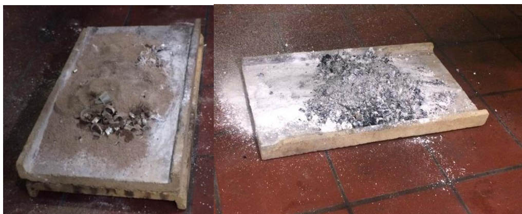
Рисунок 2.2 – Результати випробувань вогнегасних порошків для гасіння магнію
