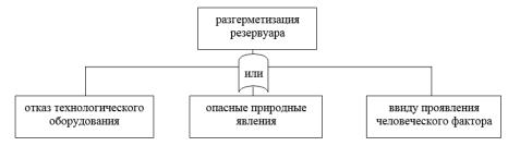
Для получения численных значений вероятности разгерметизации резервуаранеобходим сбор данных по имевшим место и возможным отказам технологического оборудования на ОАО «Гомельтранснефть Дружба».
