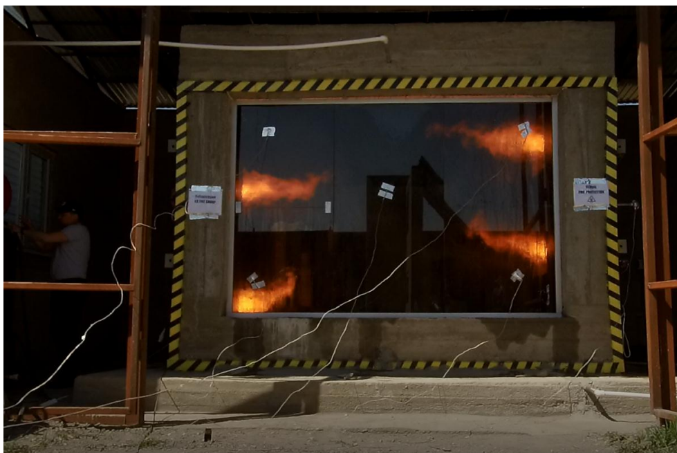
Рисунок 1 - Испытания по определению фактического предела огнестойкости стекла при реальной пожарной нагрузке
