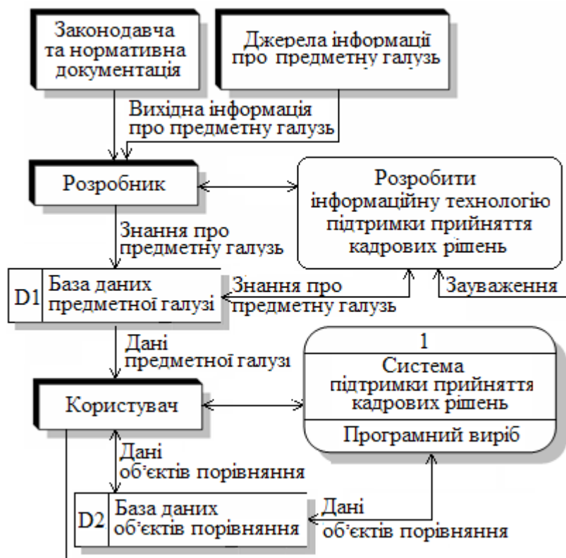
Рис. 2. Діаграма потоку даних процесу розробки інформаційної технології підтримки прийняття кадрових рішень
