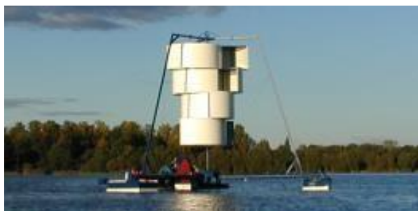
Рис. Пульверизаційний аератор води з вітровим приводом концепції Подсядловського [1]
