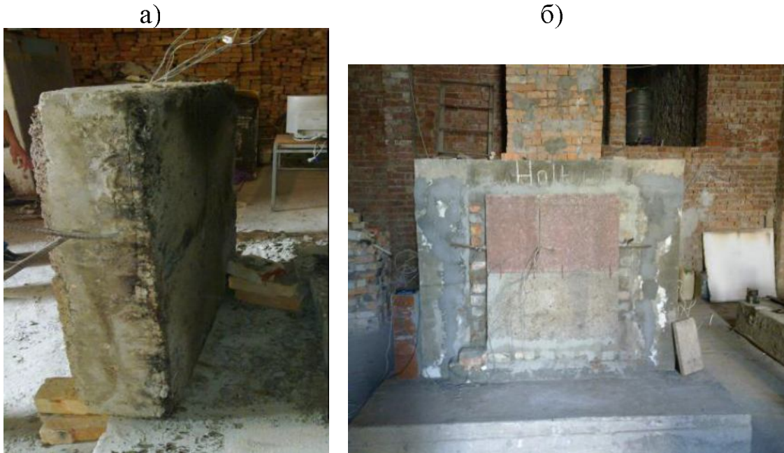
Рисунок 4.22. Вигляд дослідного зразка марки СФБ-1,2 після випробування
