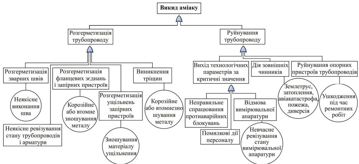
Рис. 3. "Дерево відмов" виникнення аварійних ситуацій під час експлуатації трубопроводів
