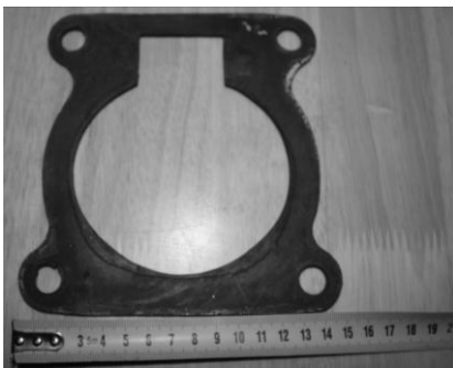
Рис. 1. Прокладка ущільнювальна напірного патрубку пожежної помпи ПН – 40УВ
