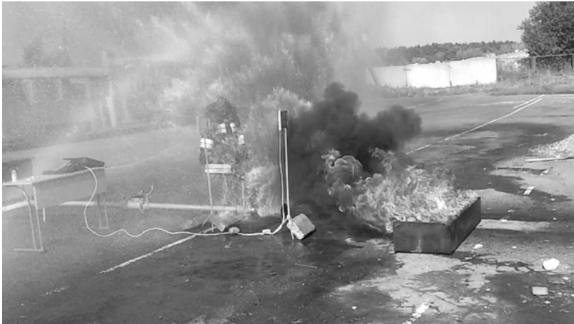
Рис. 1. Процес дослідження коефіцієнта екранування радіальною водяною завісою
