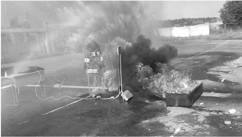
Рис. 1. Процес дослідження коефіцієнта екранування радіальною водяною завісою
