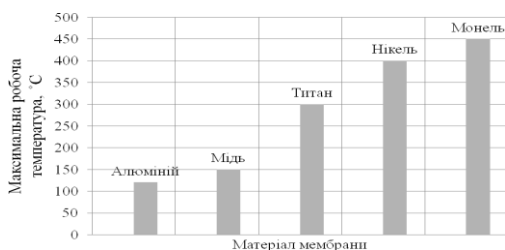
Рис. 1. Залежність максимальної температури експлуатації мембрани від виду матеріалу мембрани
