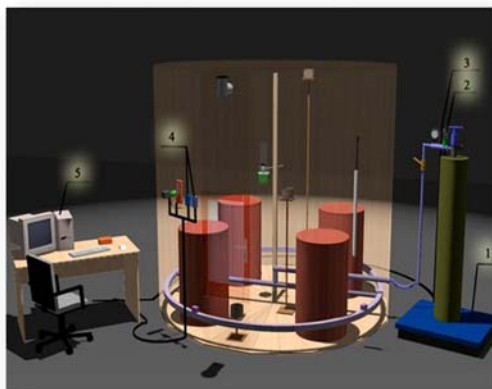
Рис. 1. Об'ємне зображення макету хвостового відсіку першої ступені ракети-носія
