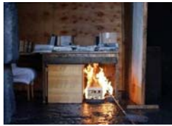
Початок підпалення пожежної навантаги газувим пальником
