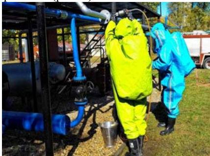
Рис. 1. Відпрацювання вправ на тренажері з використанням спеціального аварійно-рятувального обладнання для ліквідації хімічно-небезпечних розливів з трубопроводів чи ємностей
