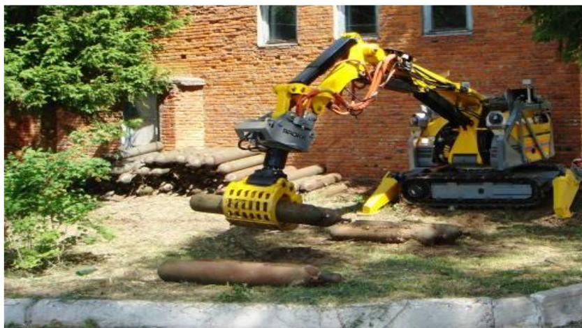
Рисунок 2- Использование робототехнического комплекса BROKK 330 D
