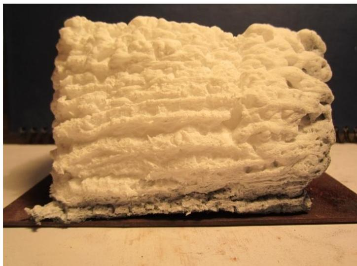
Рисунок 5 - Механизм послойного вспенивания покрытия
