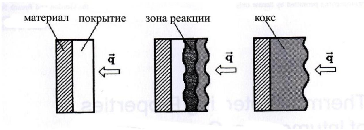
Рисунок 4 - Стадии образования пенококсового покрытия
