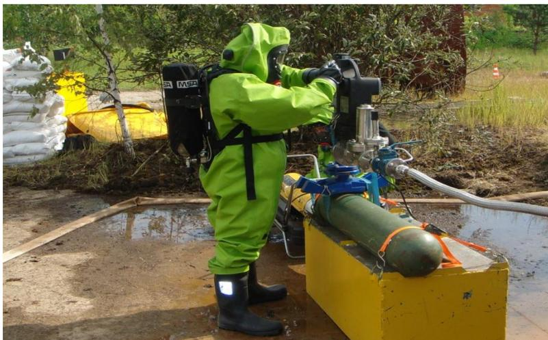
Рисунок 1 - Утилизация аварийных емкостей с хлором
