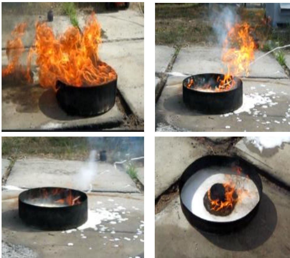
Рисунок 4.9 – Робочі моменти експериментальних досліджень вогнегасної ефективності піни низької кратності
