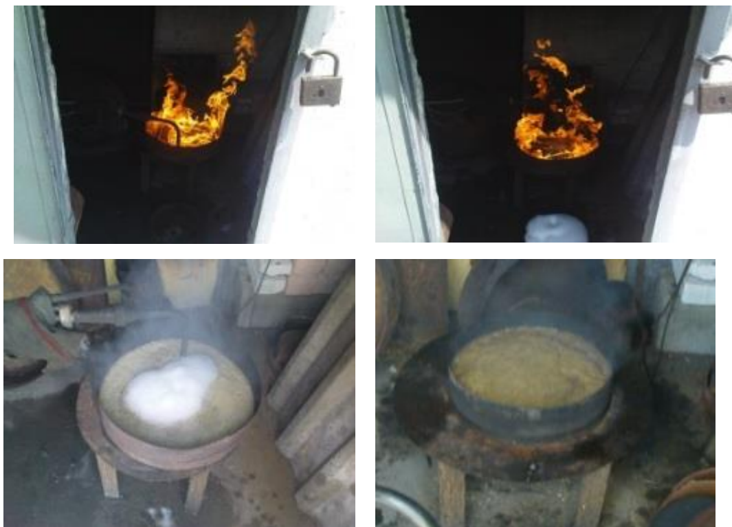
Рисунок 4.8 – Робочі моменти експериментальних досліджень вогнегасної ефективності піни середньої кратності
