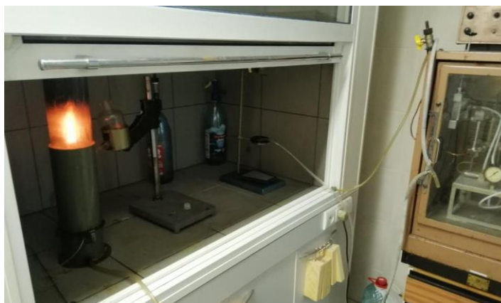
Рисунок 4.16 – Робочі моменти експериментальних досліджень мінімальної вогнегасної концентрації ГВР
