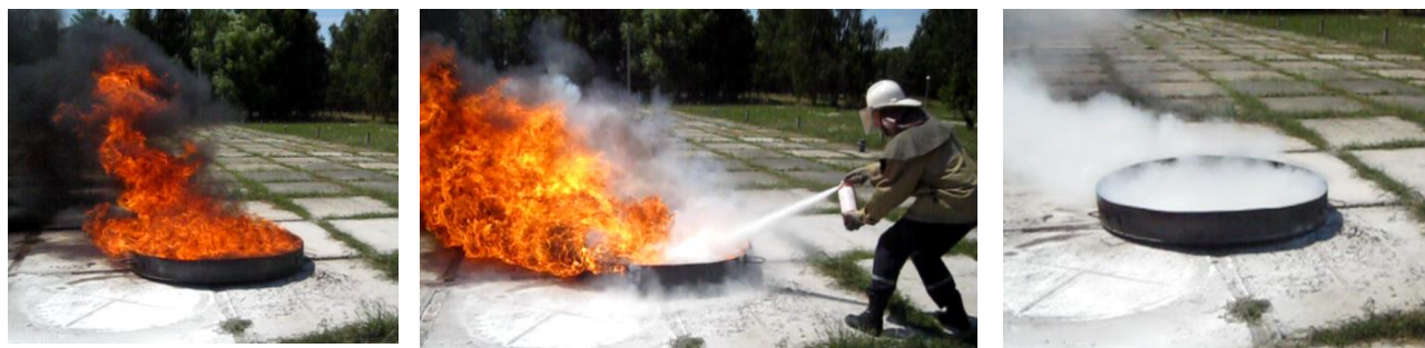
Рисунок 4.14 – Робочі моменти експериментальних досліджень вогнегасної ефективності вогнегасного порошку
