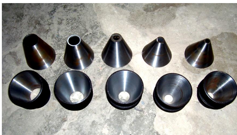
Рис. 4. Дослідні зразки цапфи опори ковзання із кутом \alpha при вершині: 30°, 35°, 40°, 45°, 50° (зліва направо)
