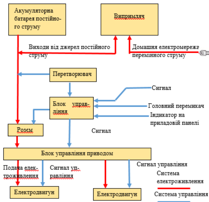
Рис. 1. Принципова схема роботи електромобілів
