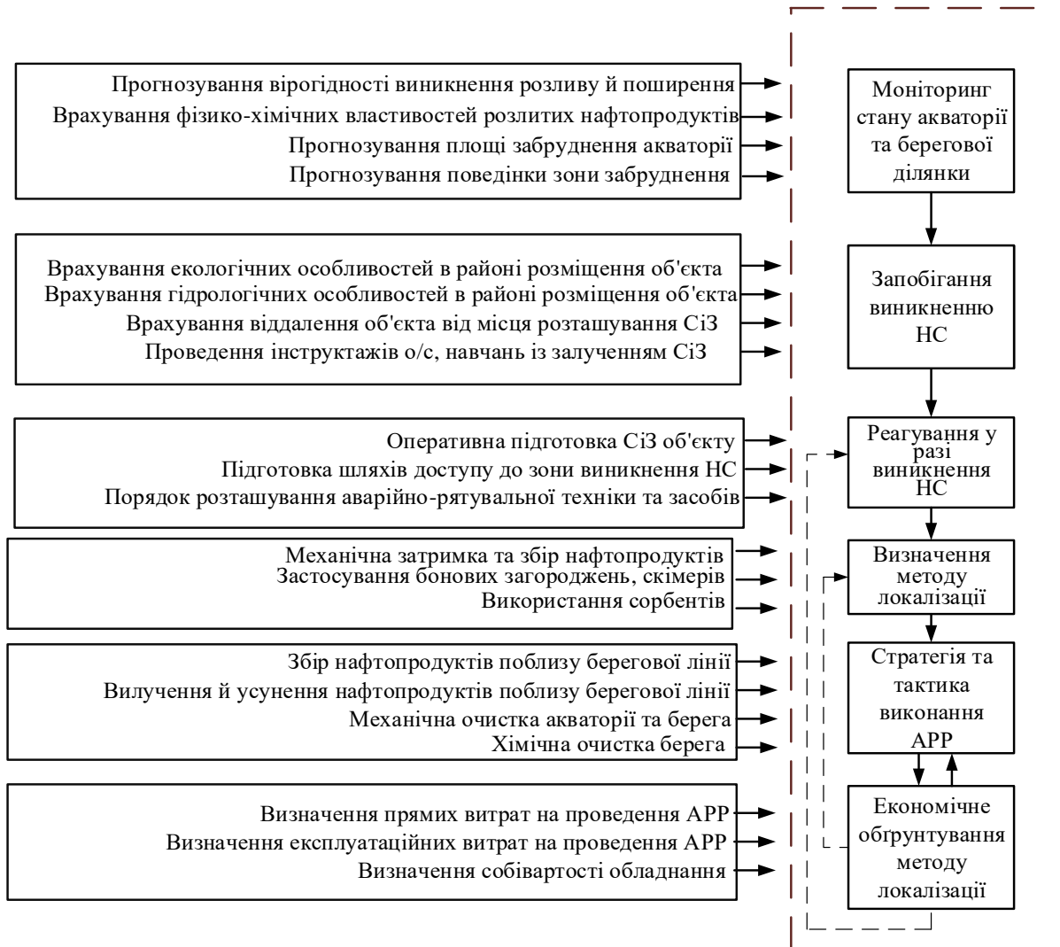
Рис. 1. Логістична схема для ліквідації надзвичайних ситуацій на об'єктах портової інфраструктури
