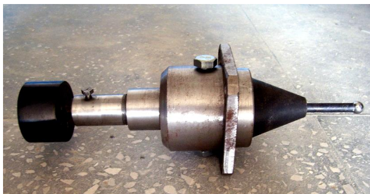
Рис. 3. Пристосування для визначення осьового навантаження
