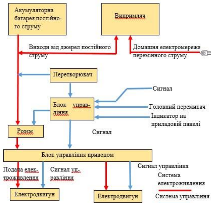
Рис. 1. Принципова схема роботи електромобілів
