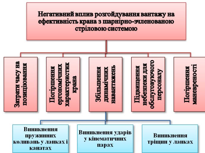
Рис. 1. Фактори негативного впливу розгойдування вантажу на стрілову систему
