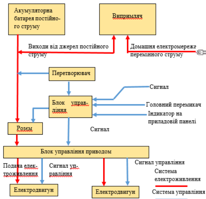
Рис. 1. Принципова схема роботи електромобілів
