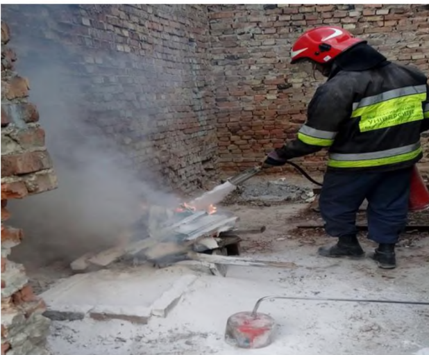
Рисунок 6 – Гасіння комбінованої пожежі деревини і магнію після подавання порошку піною підвищеної стійкості
