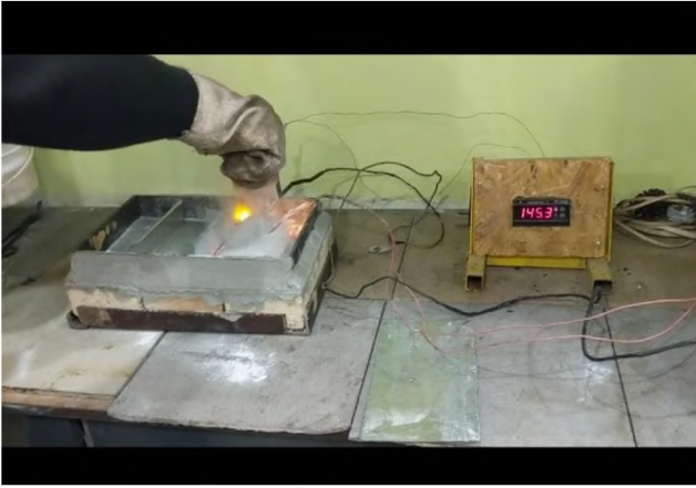
Рисунок 2 – Випробування вогнегасного порошку різної рецептури в лабораторних умовах
