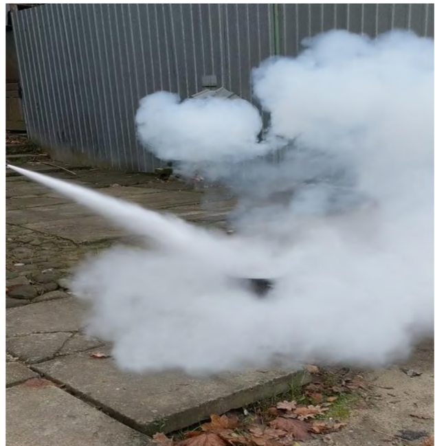
Рисунок 3 – Гасіння макетної пожежі класу В вогнегасним порошком КМ-2
