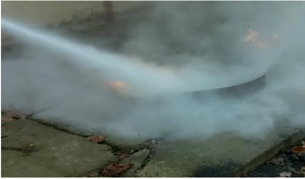
Рисунок 4 – Гасіння модельного вогнища 21В порошком КМ-2
