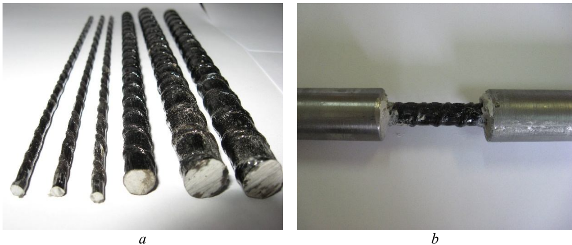
Рис. 1. Базальтова арматура (а) та експериментальні зразки (b). Fig. 1. Basalt reinforcement (a) and specimens (b).
