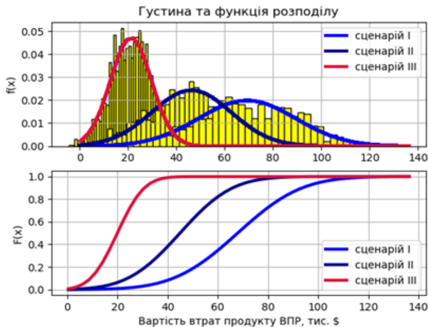
Рисунок 11 – Густина та функція розподілів вартості втрат продукту ВПР за різних сценаріїв їх реалізації
