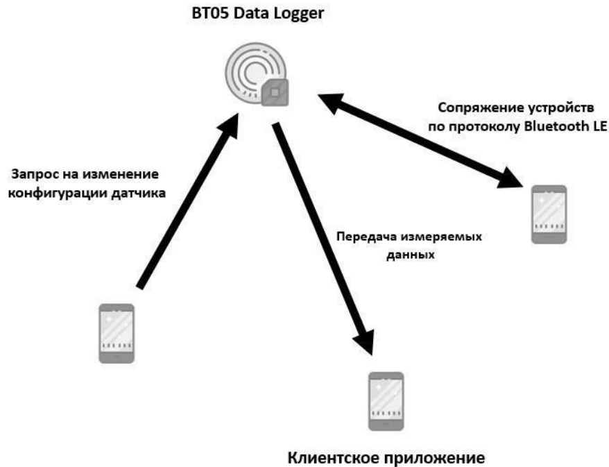
Рисунок 1 – Схема взаимодействия клиентской (мобильное приложение) и серверной (датчик) части системы мониторинга окружающей среды
