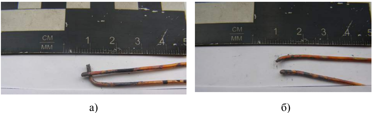
Рисунок 3.6 – Коротке замикання при температурі 400 °С: а) з витримкою 20 хв; б) з витримкою 60 хв
