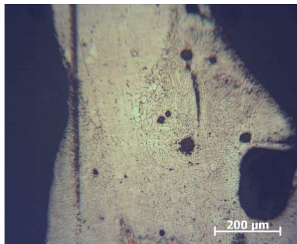
Рисунок 3.14 – Мікроструктура провідника, в якому КЗ відбулось при температурі 250 °С і витримці 60 хв
