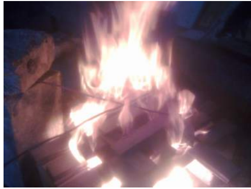
Рисунок 2.17 – Модельне вогнище, над яким прокладались провідники
