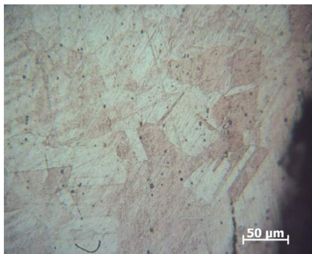
Рисунок 3.22 – Мікроструктура провідника, в якому КЗ відбулось у модельному вогнищі при температурі 800 °С
