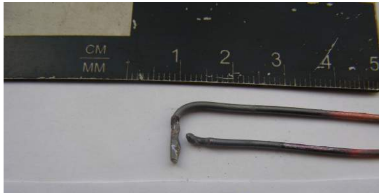
Рисунок 3.7 – Коротке замикання при температурі 950 °С
