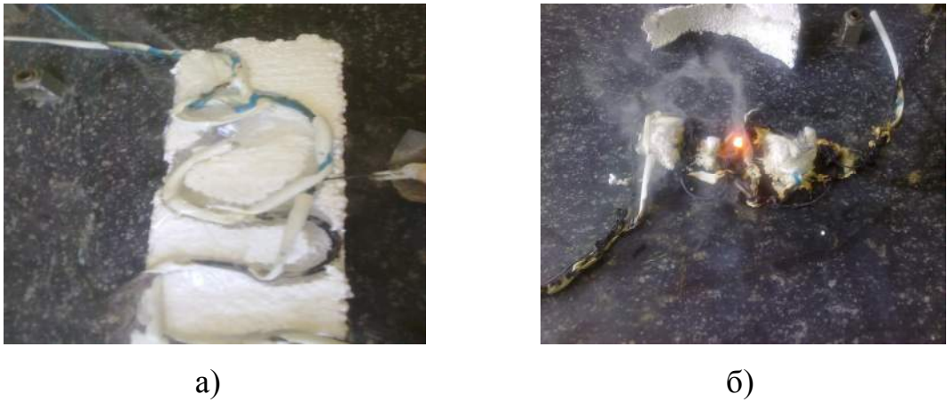
Рисунок 2.8 – Зовнішній вигляд пінополістиролу: а – до експерименту; б – після експерименту
