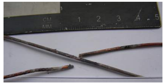
Рисунок 2.18 – Взірці провідників, в яких КЗ відбулось після згоряння ізоляції у полум'ї
