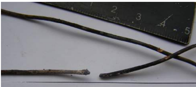
Рисунок 2.18 – Взірці провідників, в яких КЗ відбулось після згоряння ізоляції у полум'ї
