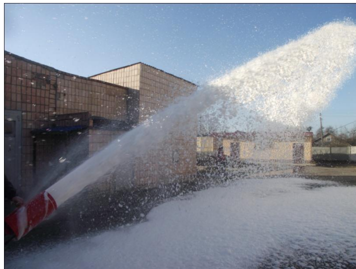
Рисунок 5.4 – Випробування піногенератора ПЛСК-200
