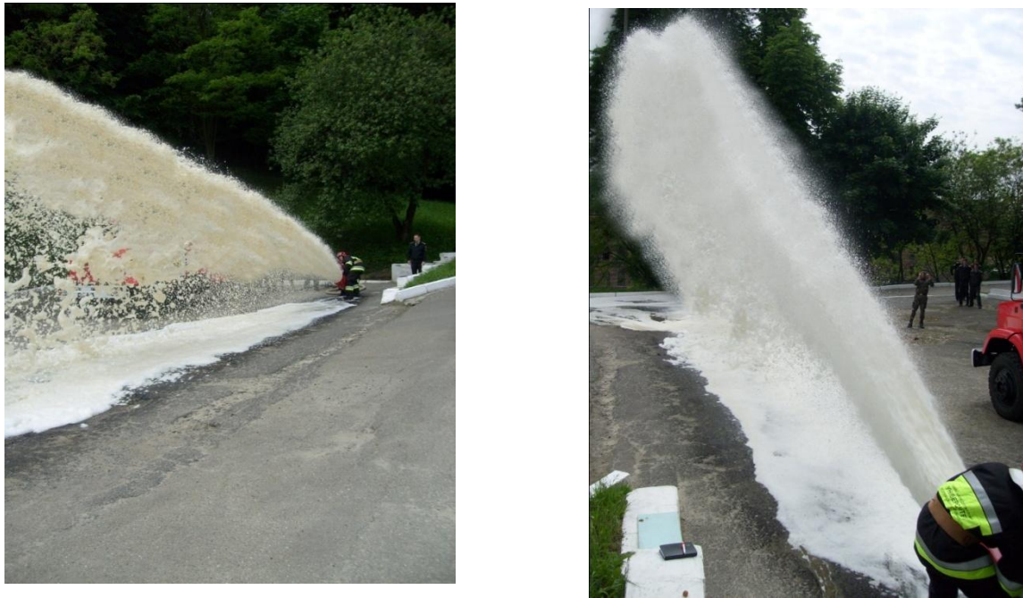
Рисунок 5.3 – Випробування генератора комбінованої піни ПЛСК-800
