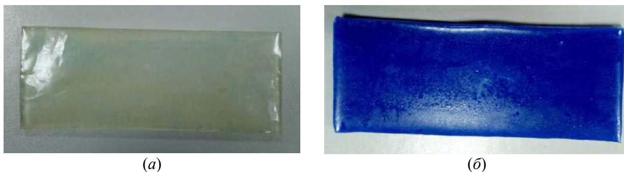
Рисунок - 1. Образцы эпоксиполимеров для экспериментальных исследований: а - без антипирена; б - с антипиреном
