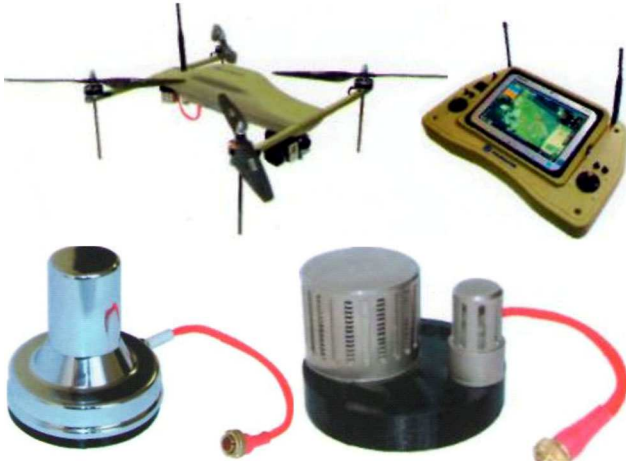
Рис. 2. Загальний вигляд БАС та змінні модулі детекторів радіаційних та хімічних речовин
