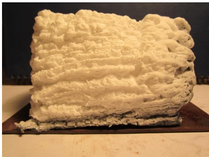
Рисунок 5 - Механизм послойного вспенивания покрытия
