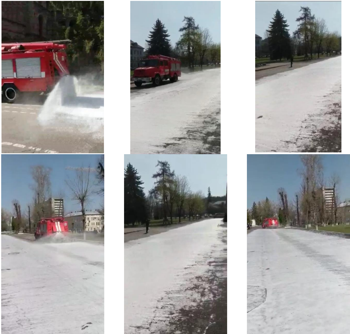
Рисунок 3.10 –Пінна загороджувальна смуга, нанесена з використанням робочого розчину піноутворювача “Барс S-2”, що забезпечує генерування піни з підвищеною стійкістю пожежною автоцистерною
