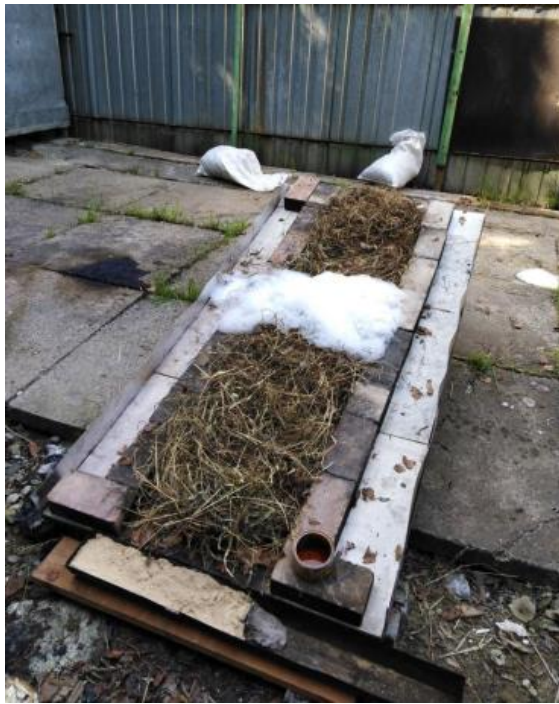
Рисунок 3.2 – Загальний вигляд установки для створення умов поширювання полум'я на трав'яних покриттях
