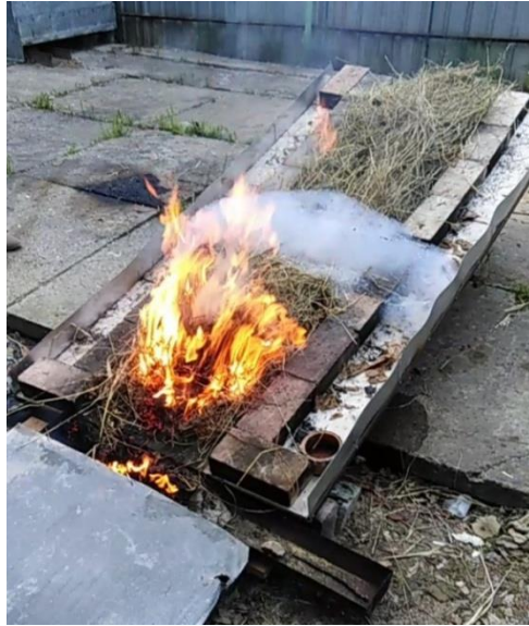
Рисунок 3.5 – Поширювання вогню експериментальною трав'яною смугою та пінна загороджувальна смуга, нанесена з використанням робочого розчину піноутворювача для гасіння пожеж “Барс S-2”, що забезпечує генерування піни з підвищеною стійкістю
