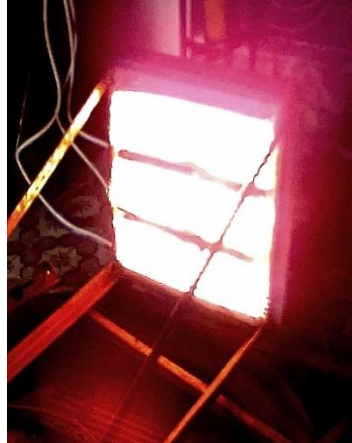
Рисунок 3.15 – Радіаційна електрична панель з потужністю теплового випромінювання 20 \text{ кВт/м}^2 .
