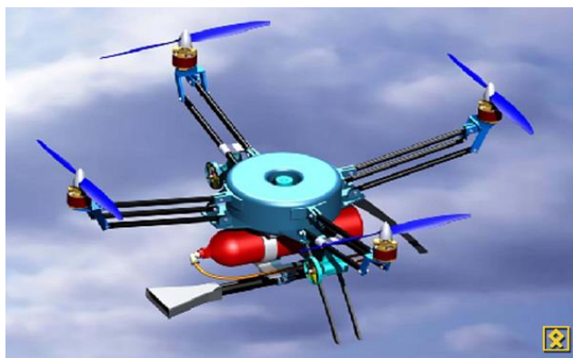
Рис. 2. Дрон Pars із установкою пожежогасіння
