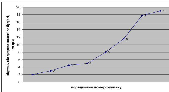
Рис. 3. Графік впливу теплового випромінювання на будівлі в залежності від відстані їх розташування
