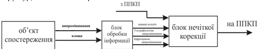
Рисунок 2 – Структурна схема пожежного сповіщувача полум’я
