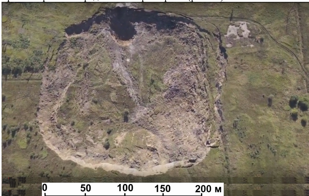
Рис. 13. Форма та розміри провалу що стався 30 вересня 2017 року на руднику № 2 Стебницького ГХП «Полімінерал» над ділянкою руйнування ціликів між камерами № 108-109-110-111-112-113 пласта № 10 ПД-Сх (зйомка з ДРОНа)
