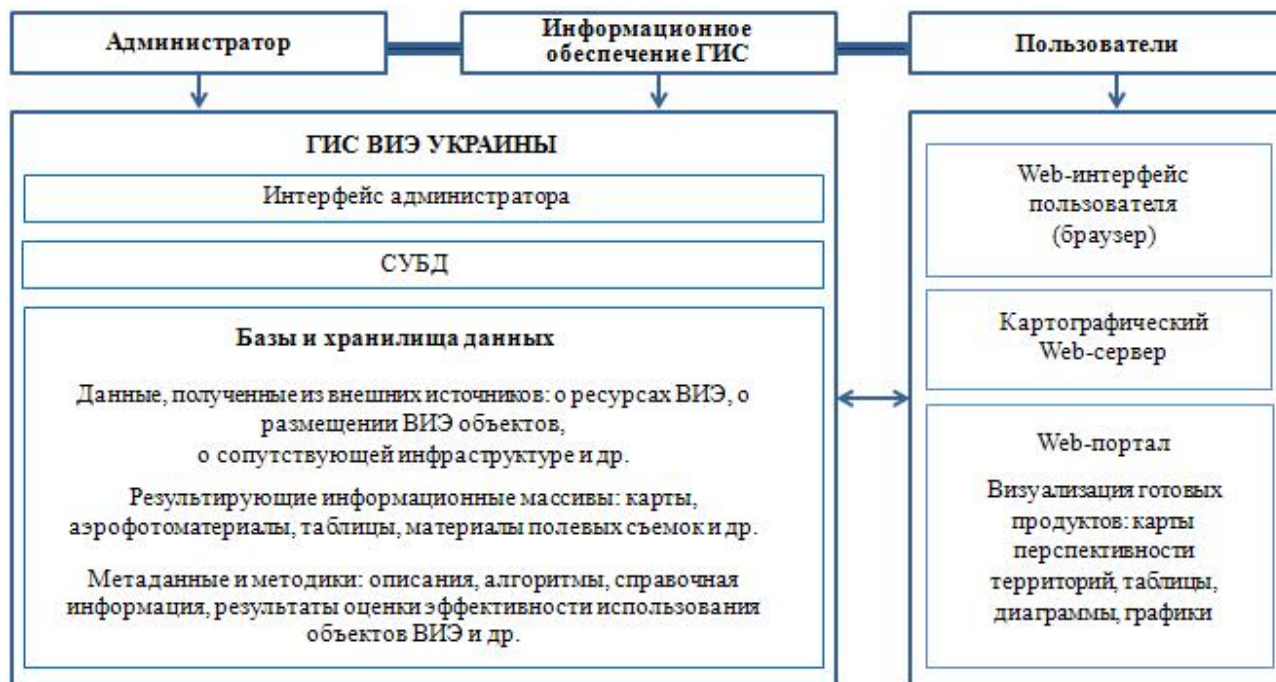
Рис. 3. Структурная схема ГИС ВИЭ Украины
