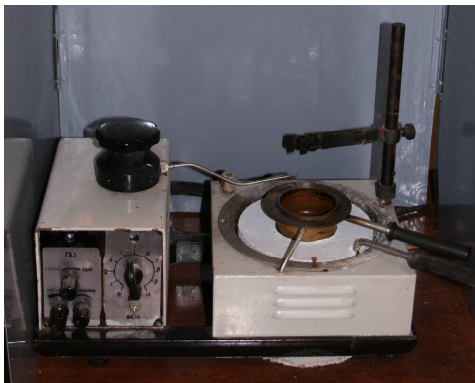
Основні складові елементи установки: нагрівна ванна, металевий чи фарфоровий тигель, тримач та штатив, газовий пальник, термометр, азбестова прокладка
