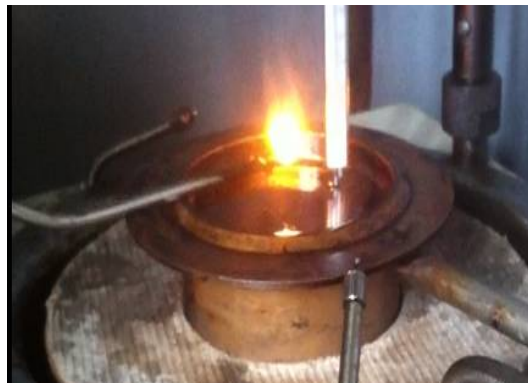
Основні складові елементи установки: нагрівна ванна, металевий чи фарфоровий тигель, тримач та штатив, газовий пальник, термометр, азбестова прокладка
