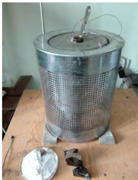
Рис. 3. Визначення температури самозаймання суміші імітату з бітумом за допомогою приладу СТС-2
