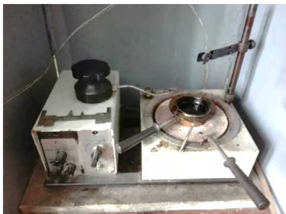
Рис. 2. Визначення температури спалаху у відкритому тиглі та температури займання суміші імітату з бітумом за допомогою приладу ТВ-2
