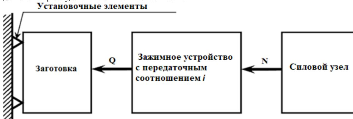
Рис.1. Структурная схема процесса зажима
