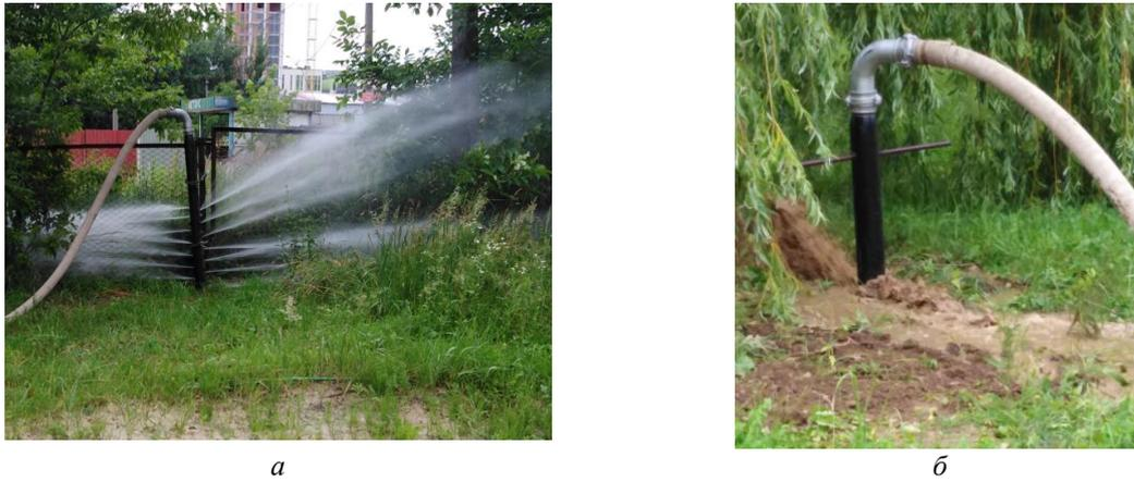
Рис. 2. Випробування дослідного зразка ствола спеціального пожежного у відкритому просторі (а) та укрученого в ґрунт (б)
